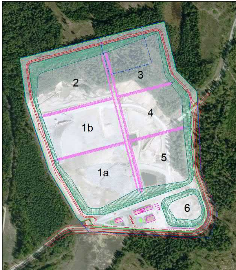
2.1 pav. Vilniaus regioninio nepavojingųjų atliekų sąvartyno schema [6]
