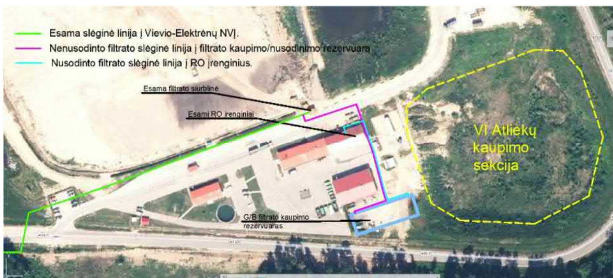
2.9 pav. Planuojamas sąvartyno filtrato tvarkymo sprendinys
