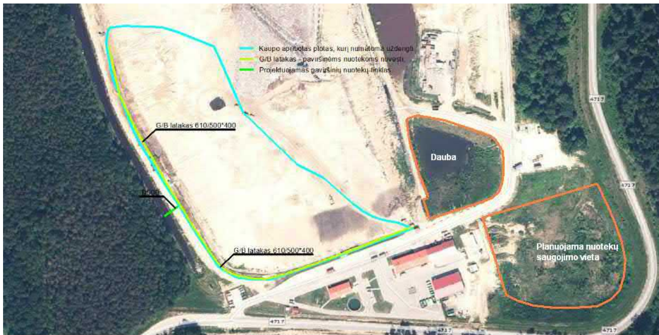
2.7 pav. Planuojamas paviršinių nuotekų saugojimo sprendinys
