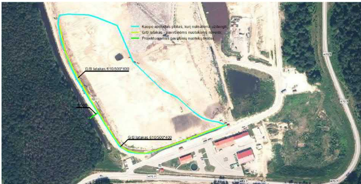
2.8 pav. Planuojamas paviršinių nuotekų nuo neeksploatuojamo sąvartyno kaupo ties aptarnavimo zona sprendinys
